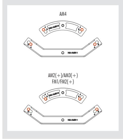
Elija las barras de montaje NM-AMB10 (cortas) o las NM-AMB11 dependiendo de la orientación final que se desee para el disipador.
