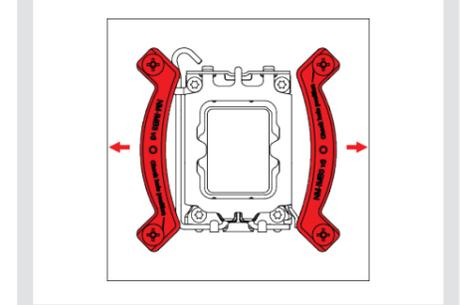
Sujete las barras de montaje con los 4 tornillos de ajuste manual.
