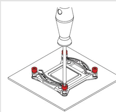
**Precaución:** Apriete los tornillos con cuidado hasta que se detengan, sin aplicar demasiada fuerza (max. par de fuerza 0.6 Nm).
