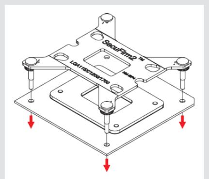
**Precaución:** La placa de soporte que se incluye se instalará sobre el soporte de la placa base, por lo que este último soporte no deberá retirarse.
