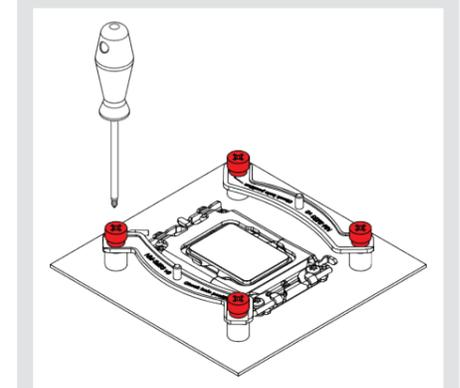
**Precaución:** Apriete los tornillos con cuidado hasta que se detengan, sin aplicar demasiada fuerza (max. par de fuerza 0.6 Nm).
