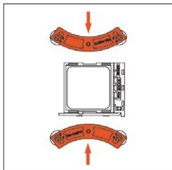
**Precaución:** Para las barras de montaje largas NM-AMB11 asegúrese de que los lados curvados apunten hacia afuera.
