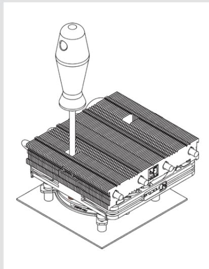
**Precaución:** Apriete los tornillos con cuidado hasta que se detengan, sin aplicar demasiada fuerza (max. par de fuerza 0.6 Nm).
