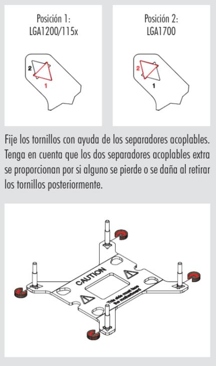
Fije los tornillos con ayuda de los separadores acoplables. Tenga en cuenta que los dos separadores acoplables extra se proporcionan por si alguno se pierde o se daña al retirar los tornillos posteriormente.
