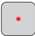
**Precaución:** Aplicar demasiada pasta térmica reducirá la conductividad del calor y el rendimiento de refrigeración.
