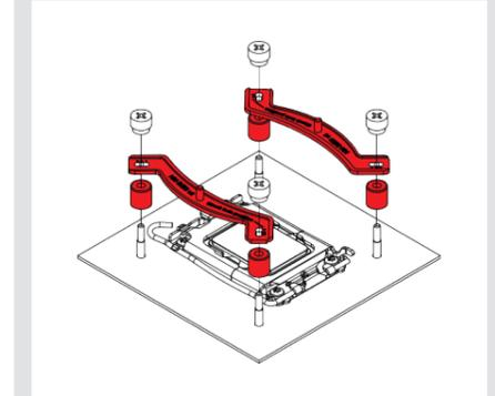
**Precaución:** Elija la alineación de las barras de montaje dependiendo de la orientación final que se desee para el disipador.
