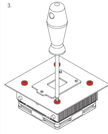
**Precaución:** Apriete los tornillos con cuidado hasta que se detengan, sin aplicar demasiada fuerza (max. par de fuerza 0.6 Nm).
