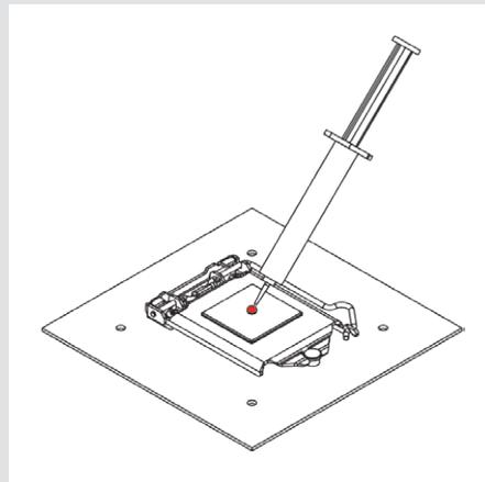
**Precaución:** Aplicar demasiada pasta térmica reducirá la conductividad del calor y el rendimiento de refrigeración.
