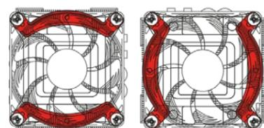
**Achtung:** Stellen Sie sicher, dass die Biegungen der Montagebrücken nach außen zeigen.
