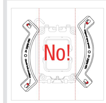
Stecken Sie zunächst die Kunststoffhülsen und anschließend die Montagebrücken auf die Stützen.
