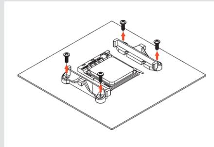
Falls auf Ihrem Mainboard kein Retention-Modul vormontiert ist, sollten Sie mit dem Mainboard-Zubehör eine originale AMD-Backplate erhalten haben. Setzen Sie die Backplate so auf die Rückseite des Mainboards, dass die Gewindestutzen der Backplate wie unten dargestellt durch die Montagelöcher des Mainboards ragen. Falls bei Ihrem Mainboard keine Backplate vormontiert oder mitgeliefert sein sollte, kontaktieren Sie bitte unser Support-Team [support@noctua.at](mailto:support@noctua.at).
