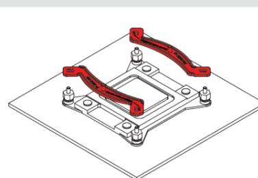
**Achtung:** Wählen Sie die Ausrichtung der Montagebrücken gemäß der gewünschten Orientierung des Kühlers.
