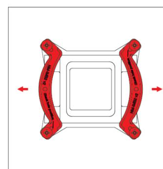
Fixieren Sie die Montagebrücken mit den 4 NM-ITS1 Rändelschrauben.
