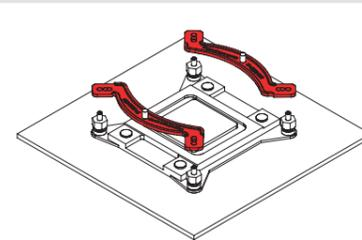
Attention: Il est important d'aligner les étriers de fixation en fonction de l'orientation finale souhaitée du radiateur.
