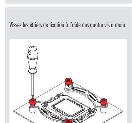
Attention: Il est important de serrer normalement, et sans excès, les vis jusqu'à leur arrêt (max. torque 0,6 Nm).
