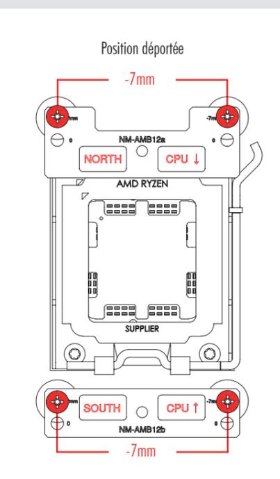
4 Fixation du ventilad sur le CPU
