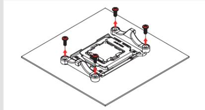
Dans le cas des AM4, le fait de dévisser le module de rétention d'origine nécessitera le maintien manuel de la plaque arrière qui n'est plus retenue. Si vous ne retrouvez pas la plaque arrière de votre AM4, veuillez nous contacter via [support@noctua.at](mailto:support@noctua.at). Pour les AM5, la plaque arrière est vissée au socket et reste donc en place lors de cette opération.
