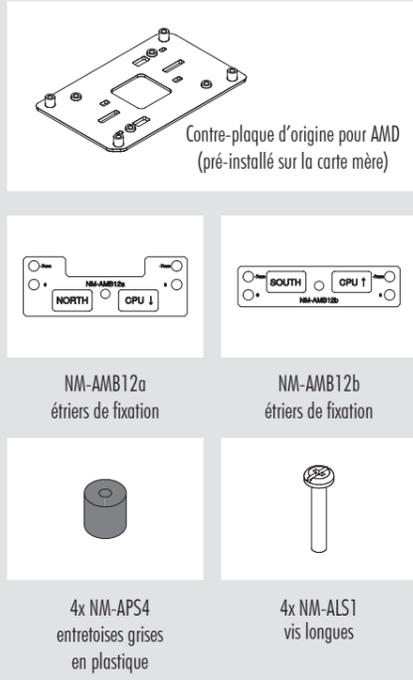
1 Enlever le système de rétention d'origine — mettre en place la contre-plaque
