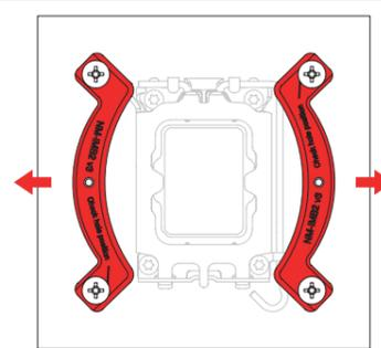
Vissez les étriers de fixation à l'aide des quatre vis à main NM-ITS1.
