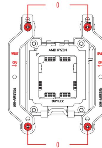
**Achtung:** Stellen Sie sicher, dass die "CPU→"-Markierungen zur CPU zeigen und dass die NM-AMB12a Montagebrücke mit der Markierung "NORTH" auf der nördlichen (oberen) Seite des Sockels und die NM-AMB12b Montagebrücke mit der Markierung "SOUTH" auf der südlichen (unteren) Seite des Sockels installiert wird, wie oben gezeigt.
