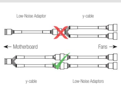
**Achtung:** Überprüfen Sie bei der Verwendung der L.N.A. die Temperatur Ihrer CPU mittels entsprechender Software (z.B. der entsprechenden Applikation Ihres Mainboard-Herstellers), um eine automatische Drosselung der CPU wegen der erhöhten Temperatur zu vermeiden. Falls die Kühlleistung unzureichend sein sollte, erhöhen Sie bitte die Gehäusebelüftung oder entfernen Sie die L.N.A.
