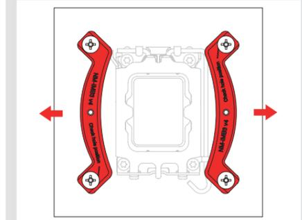
Fixieren Sie die Montagebrücken mit den 4 NM-ITS1 Rändelschrauben.
