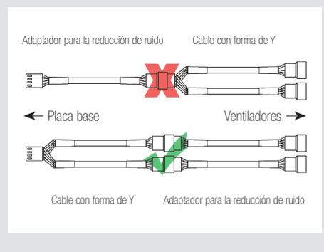
**Precaución:** Cuando utilice el adaptador L.N.A., compruebe la temperatura de su CPU utilizando un software apropiado (p.ej., las respectivas aplicaciones del fabricante de su placa base) con el fin de evitar el funcionamiento irregular de la CPU debido al aumento de la temperatura. Si el rendimiento de refrigeración es insuficiente, aumente la ventilación de la caja o retire el adaptador L.N.A.
