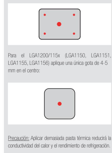
**Precaución:** Aplicar demasiada pasta térmica reducirá la conductividad del calor y el rendimiento de refrigeración.
