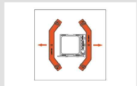
**Precaución:** Apriete los tornillos con cuidado hasta que se detengan, sin aplicar demasiada fuerza (max. par de fuerza 0.6 Nm).
