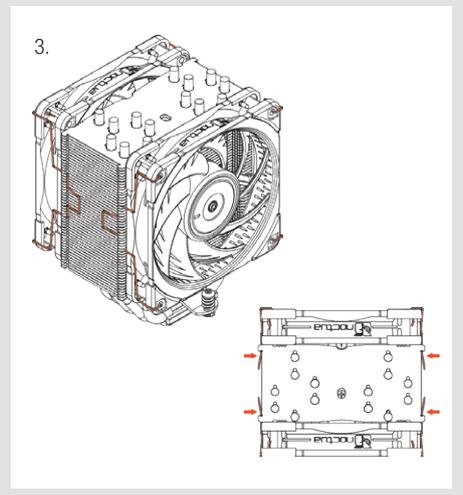
Conecte el ventilador(es) al conector(es) del ventilador de la CPU de la placa base. Si fuera necesario, utilice el cable con forma de Y NA-YC1 para conectar ambos ventiladores a un solo conector del ventilador.
