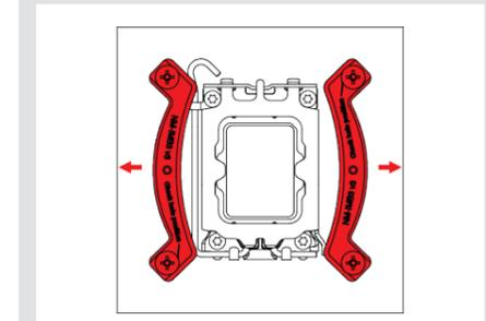
Sujete las barras de montaje con los 4 tornillos de ajuste manual NM-ITS1.
