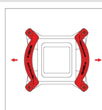
Sujete las barras de montaje con los 4 tornillos de ajuste manual NM-ITS1.
