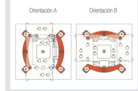
**Precaución:** Compruebe que los lados curvados de las barras de montaje estén orientados hacia afuera.
