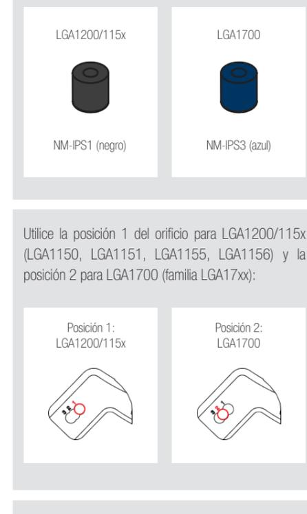
**Precaución:** Compruebe que utiliza la posición correcta del orificio en ambos extremos de las barras de montaje NM-IMB3 para que estén bien alineadas.
