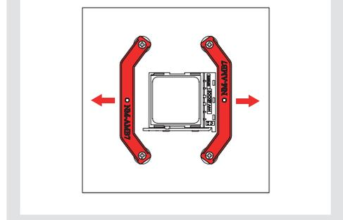
**Attention :** Il est important de serrer normalement, et sans excès, les vis jusqu'à leur arrêt (max. torque 0,6 Nm).
