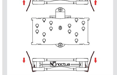
Positionnez à présent le ventilad sur le CPU et fixez celui-ci sur les filetages présents sur les étriers de montage. Commencez le serrage des vis en effectuant 2-3 tours de tournevis pour chacune d'elle puis répétez l'opération jusqu'à ce que les deux vis soient totalement serrées.
