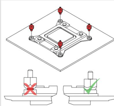
Positionnez à présent les étriers de fixation NM-IMB3 au dessus des boulons.
