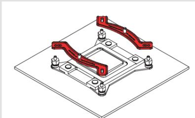
**Attention:** il est important d'aligner les étriers de fixation en fonction de l'orientation finale souhaitée du radiateur.
