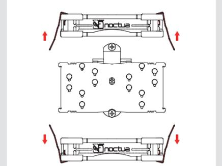
Positionnez à présent le ventilad sur le CPU et fixez celui-ci sur les filetages présents sur les étriers de montage. Commencez le serrage des vis en effectuant 2-3 tours de tournevis pour chacune d'elle puis répétez l'opération jusqu'à ce que les deux vis soient totalement serrées.
