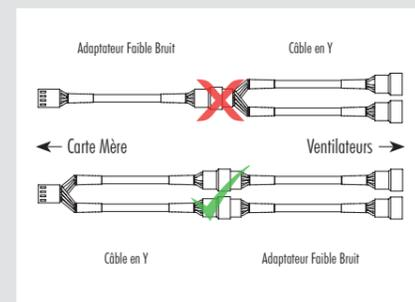
**Attention:** en cas d'utilisation de l'adaptateur L.N.A., veuillez vérifier la température de votre CPU à l'aide d'un outil logiciel adapté (ex: l'application disponible auprès du fabricant de votre carte mère) afin d'éviter le passage automatique de votre CPU en mode throttling, déclenché par une température trop élevée. Si le refroidissement s'avérait insuffisant, veuillez augmenter la ventilation du boîtier ou supprimer l'adaptateur L.N.A.
