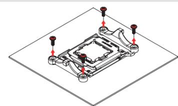
Dans le cas des AM4, le fait de dévisser le module de rétention d'origine nécessitera le maintien manuel de la plaque arrière qui n'est plus retenue. Si vous ne retrouvez pas la plaque arrière de votre AM4, veuillez nous contacter via [support@noctua.at](mailto:support@noctua.at). Pour les AM5, la plaque arrière est vissée au socket et reste donc en place lors de cette opération.
