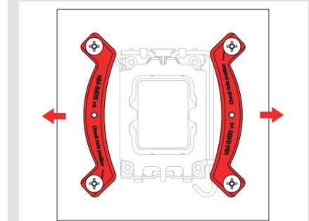
Vissez les étriers de fixation à l'aide des quatre vis à main NM-ITS1.
