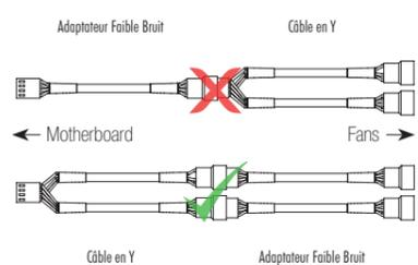
**Attention :** en cas d'utilisation de l'adaptateur L.N.A., veuillez vérifier la température de votre CPU à l'aide d'un outil logiciel adapté (ex: l'application disponible auprès du fabricant de votre carte mère) afin d'éviter le passage automatique de votre CPU en mode throttling, déclenché par une température trop élevée. Si le refroidissement s'avérait insuffisant, veuillez augmenter la ventilation du boîtier ou supprimer l'adaptateur L.N.A.
