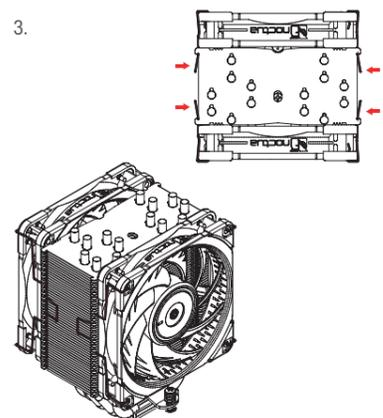
Branchez le(s) ventilateur(s) à un des connecteurs de ventilation situés sur la carte mère. Si besoin utilisez le câble en Y YC1 pour brancher deux ventilateurs à un même connecteur de ventilation.
