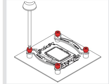
**Attention :** Il est important de serrer normalement, et sans excès, les vis jusqu'à leur arrêt (max. torque 0,6 Nm).
