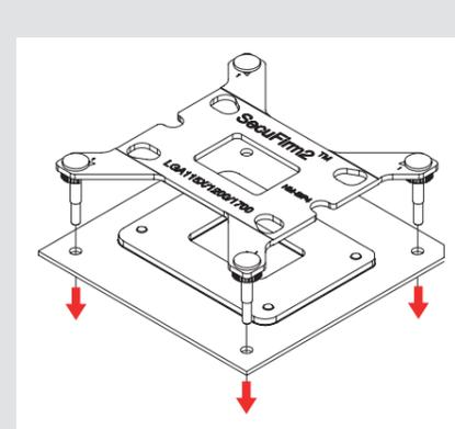
**Precaución:** La placa de soporte que se incluye se instalará sobre el soporte de la placa base, por lo que este último soporte no deberá retirarse.
