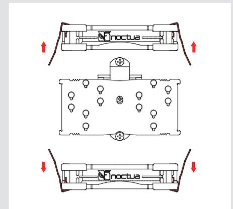
Coloque a continuación el disipador sobre la CPU y atornillelo a los orificios de las barras de montaje. Dé 2-3 vueltas en cada tornillo, después repita la operación hasta que ambos estén completamente apretados.
