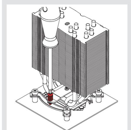
**Precaución:** Apriete los tornillos con cuidado hasta que se detengan, sin aplicar demasiada fuerza (max. par de fuerza 0,6 Nm).
