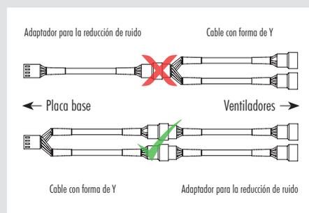
**Precaución:** Cuando utilice el adaptador L.N.A., compruebe la temperatura de su CPU utilizando un software apropiado (p.ej., las respectivas aplicaciones del fabricante de su placa base) con el fin de evitar el funcionamiento irregular de la CPU debido al aumento de la temperatura. Si el rendimiento de refrigeración es insuficiente, aumente la ventilación de la caja o retire el adaptador L.N.A.
