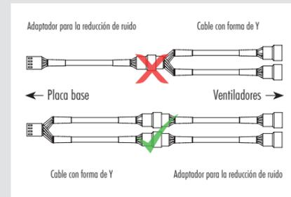
**Precaución:** Cuando utilice el adaptador L.N.A., compruebe la temperatura de su CPU utilizando un software apropiado (p.ej., las respectivas aplicaciones del fabricante de su placa base) con el fin de evitar el funcionamiento irregular de la CPU debido al aumento de la temperatura. Si el rendimiento de refrigeración es insuficiente, aumente la ventilación de la caja o retire el adaptador L.N.A.
