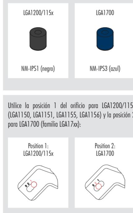
**Precaución:** Compruebe que utiliza la posición correcta del orificio en ambos extremos de las barras de montaje para que estén bien alineadas.
