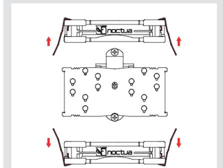
Coloque a continuación el disipador sobre la CPU y atorníllelo a los orificios de las barras de montaje. Dé 2-3 vueltas en cada tornillo, después repita la operación hasta que ambos estén completamente apretados.
