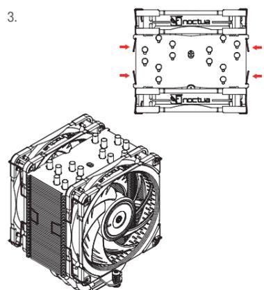
Conecte el ventilador(es) al conector(es) del ventilador de la CPU de la placa base. Si fuera necesario, utilice el cable con forma de Y NA-YC1 para conectar ambos ventiladores a un solo conector del ventilador.
