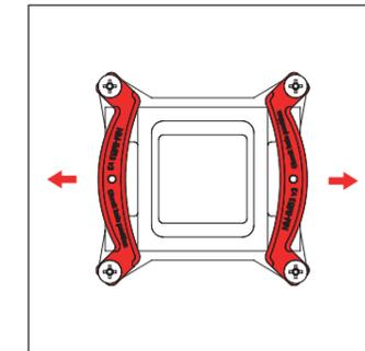
Fije las barras de montaje empleando los cuatro tornillos manuales.
