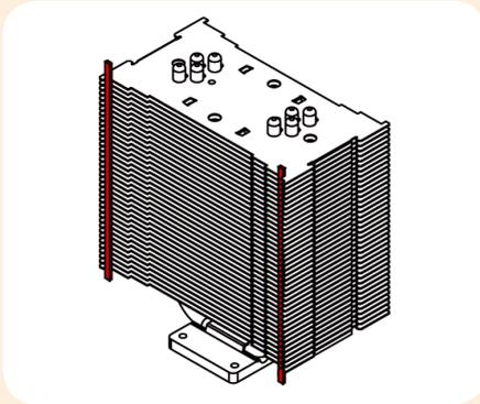
Fixez ensuite le ventilateur au dissipateur en utilisant les deux agrafes métalliques et en veillant à ce qu'il souffle dans le dissipateur (vous pouvez aussi utiliser les deux agrafes optionnelles dédiées à l'ajout d'un deuxième ventilateur).
