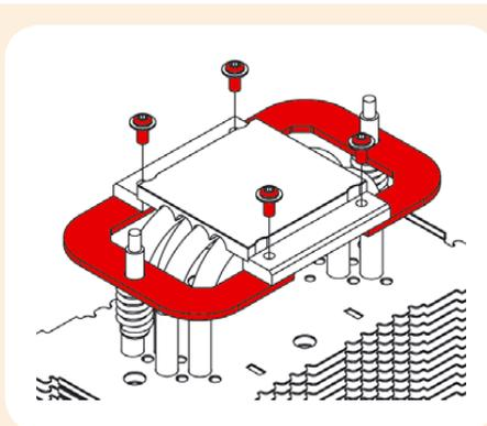
Si vous utilisez les étriers à 90°, insérer d'abord les vis avec ressorts de compression sur les étriers. Vissez-les fermement sur la base en cuivre du dissipateur en utilisant 4 vis courtes.
