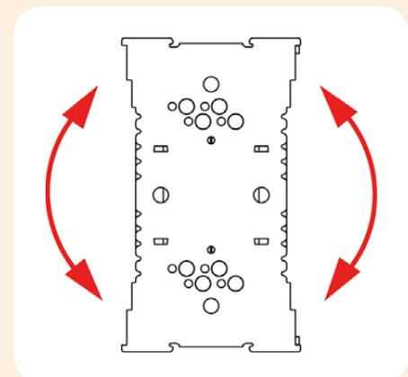
Positionnez le dissipateur sur le CPU et effectuez un déplacement avant-arrière afin d'étaler la pâte.
