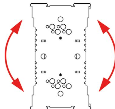
Positionnez le dissipateur sur le CPU et effectuez un déplacement avant-arrière afin d'étaler la pâte.
