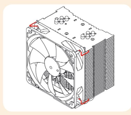
Connectez le ventilateur à la carte mère, à l'alimentation ou à un rhéostat. Suivant votre CPU et en fonction de la température du boîtier, vous pouvez éventuellement insérer l'adaptateur L.N.A. (pour Low-Noise Adapter) ou U.L.N.A. (pour Ultra-Low-Noise Adapter) sur le cordon d'alimentation afin de réduire encore le bruit de fonctionnement.
