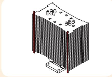
Fixez ensuite le ventilateur au dissipateur en utilisant les deux agrafes métalliques et en veillant à ce qu'il souffle dans le dissipateur (vous pouvez aussi utiliser les deux agrafes optionnelles dédiées à l'ajout d'un deuxième ventilateur).
