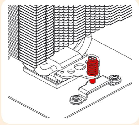
L'utilisation des étriers à 90° impose l'utilisation de l'outil de montage fourni afin de maintenir les vis à ressorts de compression.
