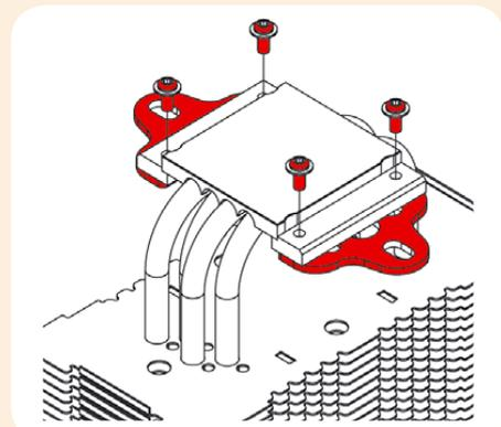
En cas d'utilisation des étriers standards, vissez ces derniers fermement sur la base en cuivre du dissipateur en utilisant 4 vis courtes.
