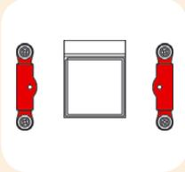
Placez les 4 rondelles blanches fines sous les étriers ; de même placez les 4 rondelles rouges épaisses sur le dessus des étriers. Vissez à présent les étriers à la plaque arrière de fixation en utilisant les petites vis à pas de filetage large (fournies dans le sachet AM2(+)).
