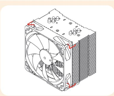
Connectez le ventilateur à la carte mère, à l'alimentation ou à un rhéostat. Suivant votre CPU et en fonction de la température du boîtier, vous pouvez éventuellement insérer
