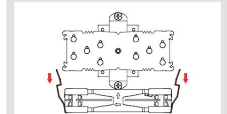
Coloque a continuación el disipador sobre la CPU y atornillelo a los orificios de las barras de montaje. Dé 2-3 vueltas en cada tornillo, después repita la operación hasta que ambos estén completamente apretados.
