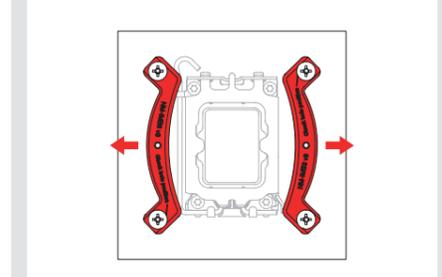
Sujete las barras de montaje con los 4 tornillos de ajuste manual.
