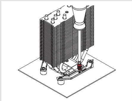
**Precaución:** Apriete los tornillos con cuidado hasta que se detengan, sin aplicar demasiada fuerza (max. par de fuerza 0,6 Nm).
