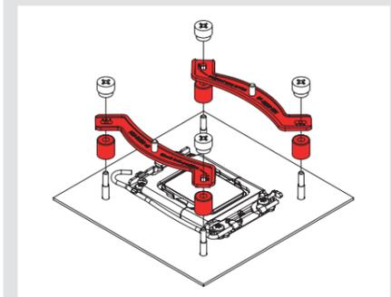
**Precaución:** Elija la alineación de las barras de montaje dependiendo de la orientación final que se desee para el disipador.
