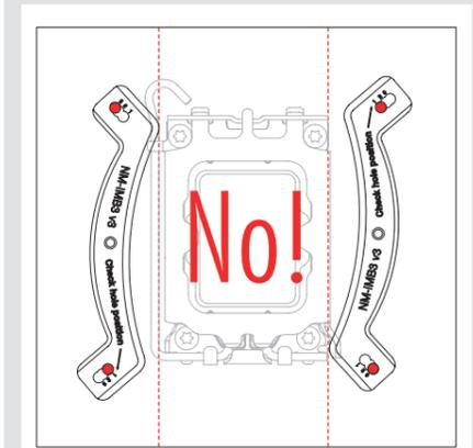
Introduzca los separadores de plástico en los tornillos de la placa de soporte, después incorpore las barras de montaje.
