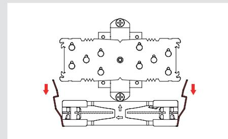
Coloque a continuación el disipador sobre la CPU y atorníllelo a los orificios de las barras de montaje.
