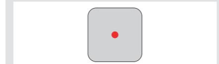
**Precaución:** Aplicar demasiada pasta térmica reducirá la conductividad del calor y el rendimiento de refrigeración.
