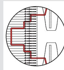
Aunque Noctua recomienda utilizar un ventilador NF-F12 para conseguir los mejores resultados cuando se opta por el modo de ventilador doble, el juego extra de clips puede utilizarse también para instalar la mayoría de ventiladores. En este caso, pegue las tiras adhesivas anti vibración en el disipador para evitar que las vibraciones se transmitan al disipador.
