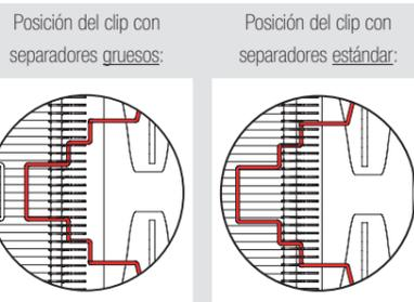
Aunque Noctua recomienda utilizar un ventilador NF-F12 para conseguir los mejores resultados cuando se opta por el modo de ventilador doble, el juego extra de clips puede utilizarse también para instalar la mayoría de ventiladores. En este caso, pégue las tiras adhesivas anti vibración en el disipador para evitar que las vibraciones se transmitan al disipador.
