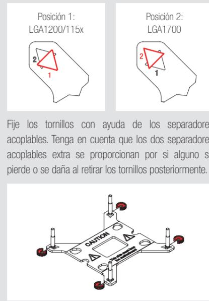
Fije los tornillos con ayuda de los separadores acoplables. Tenga en cuenta que los dos separadores acoplables extra se proporcionan por si alguno se pierde o se daña al retirar los tornillos posteriormente.
