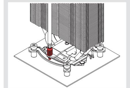
**Precaución:** Apriete los tornillos con cuidado hasta que se detengan, sin aplicar demasiada fuerza (max. par de fuerza 0,6 Nm).
