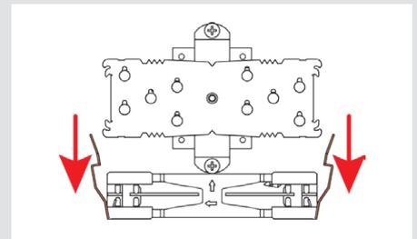
Setzen Sie anschließend den Kühler auf die CPU und schrauben Sie ihn an die Schraubenstützen der Montagebrücken. Führen Sie jeweils 2-3 Umdrehungen pro Schraube aus und wechseln Sie zwischen den Schrauben hin und her, bis beide vollständig angezogen sind.
