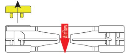
2. Befestigen Sie die dickeren Pads auf dem hinteren Lüfter
