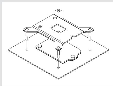
**Achtung:** Die ab Werk am Mainboard verbaute Backplate muss nicht abgenommen werden. Die Backplate des Kühlers wird über der Backplate des Mainboards installiert.
