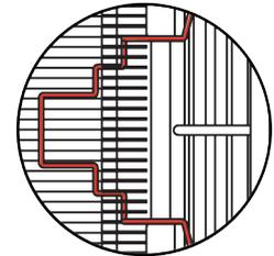
Noctua empfiehlt für beste Resultate im Doppellüfter-Betrieb die Verwendung eines original NF-F12 Lüfters. Die zusätzlichen Lüfterklammern können jedoch auch zur Befestigung vieler anderer handelsüblicher 120mm Lüfter verwendet werden. Nutzen Sie in diesem Fall bitte die mitgelieferten selbstklebenden Anti-Vibrations-Streifen, um die Übertragung von Vibrationen auf den Kühlkörper zu minimieren.
