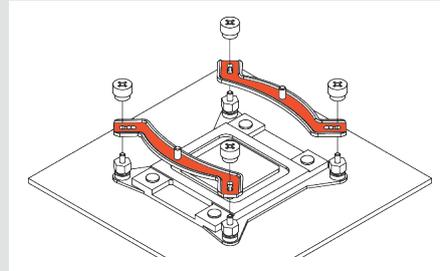
**Achtung:** Wählen Sie die Ausrichtung der Montagebrücken gemäß der gewünschten Orientierung des Kühlers.
