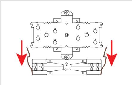
Setzen Sie anschließend den Kühler auf die CPU und schrauben Sie ihn an die Schraubenstützen der Montagebrücken. Führen Sie jeweils 2-3 Umdrehungen pro Schraube aus und wechseln Sie zwischen den Schrauben hin und her, bis beide vollständig angezogen sind.
