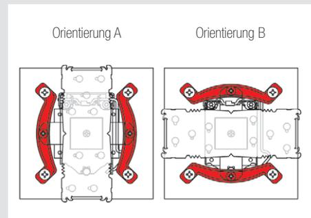
**Achtung:** Stellen Sie sicher, dass die Biegungen der Montagebrücken nach außen zeigen.
