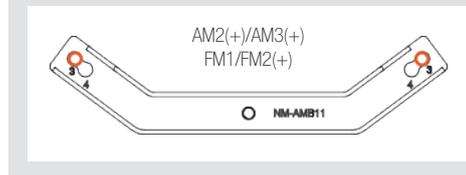
Setzen Sie zunächst die Kunststoffhülsen auf die Gewindestutzen und befestigen Sie anschließend die Montagebrücken mit den vier langen Schrauben.
