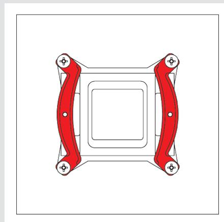
Fixieren Sie die Montagebrücken mit den 4 Rändelschrauben.
