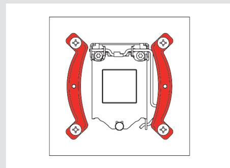
Fixieren Sie die Montagebrücken mit den 4 Rändelschrauben.
