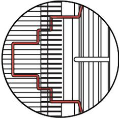
Noctua empfiehlt für beste Resultate im Doppellüfter-Betrieb die Verwendung eines originalen NF-F12 Lüfters. Die zusätzlichen Lüfterklammern können jedoch auch zur Befestigung vieler anderer handelsüblicher 120mm Lüfter verwendet werden. Nutzen Sie in diesem Fall bitte die mitgelieferten selbstklebenden Anti-Vibrations-Streifen, um die Übertragung von Vibrationen auf den Kühlkörper zu minimieren.
