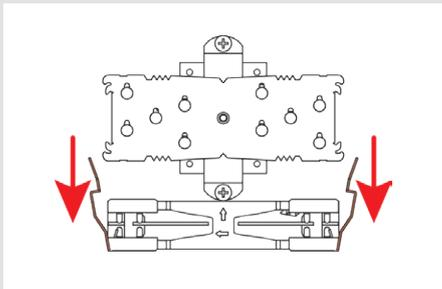
Setzen Sie anschließend den Kühler auf die CPU und schrauben Sie ihn an die Schraubenstützen der Montagebrücken. Führen Sie jeweils 2-3 Umdrehungen pro Schraube aus und wechseln Sie zwischen den Schrauben hin und her, bis beide vollständig angezogen sind.
