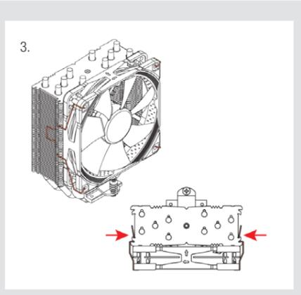
Schließen Sie den Lüfter am CPU-Lüfteranschluss Ihres Mainboards an. Je nach CPU- und Gehäuse-temperatur können Sie die mitgelieferten NA-RC6 Low-Noise Adapter (L.N.A.) zwischenschalten, um das Betriebsgeräusch des Lüfters weiter zu reduzieren.
