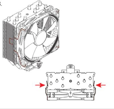
Schließen Sie den Lüfter am CPU-Lüfteranschluss Ihres Mainboards an. Je nach CPU- und Gehäusetemperatur können Sie die mitgelieferten NA-RC6 Low-Noise Adapter (L.N.A.) zwischenschalten, um das Betriebsgeräusch des Lüfters weiter zu reduzieren.
