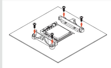
Falls auf Ihrem Mainboard kein Retention-Modul vormontiert ist, sollten Sie mit dem Mainboard-Zubehör eine originale AMD-Backplate erhalten haben. Setzen Sie die Backplate so auf die Rückseite des Mainboards, dass die Gewindestützen der Backplate wie unten dargestellt durch die Montagelöcher des Mainboards ragen. Falls bei Ihrem Mainboard keine Backplate vormontiert oder mitgeliefert sein sollte, kontaktieren Sie bitte unser Support-Team [support@noctua.at](mailto:support@noctua.at).
