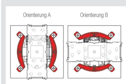
**Achtung:** Stellen Sie sicher, dass die Biegungen der Montagebrücken nach außen zeigen.
