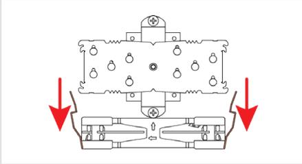
Setzen Sie anschließend den Kühler auf die CPU und schrauben Sie ihn an die Schraubenstützen der Montagebrücken. Führen Sie jeweils 2-3 Umdrehungen pro Schraube aus und wechseln Sie zwischen den Schrauben hin und her, bis beide vollständig angezogen sind.
