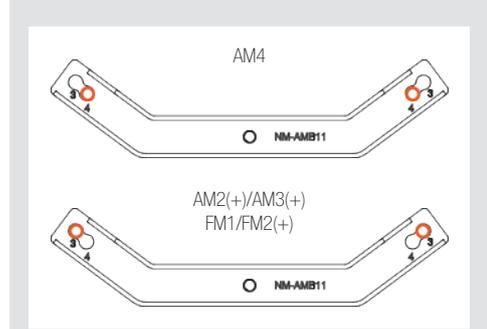
Setzen Sie zunächst die Kunststoffhülsen auf die Gewindestützen und befestigen Sie anschließend die Montagebrücken mit den vier langen NM-ALS1 Schrauben.
