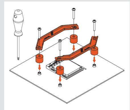
**Achtung:** Stellen Sie sicher, dass die Biegungen der Montagebrücken nach außen zeigen.
