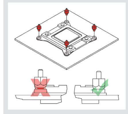
Setzen Sie nun die NM-IMB3 Montagebrücken auf die Bolzen.
