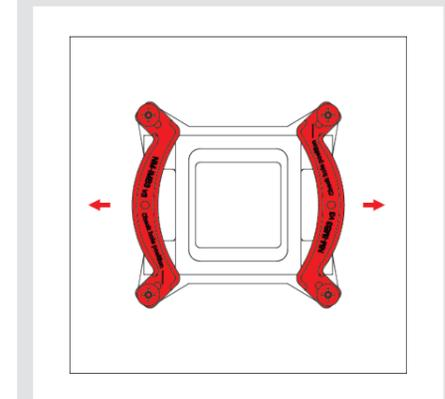
Fixieren Sie die Montagebrücken mit den 4 NM-ITS1 Rändelschrauben.
