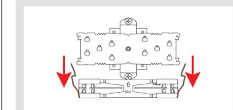
Setzen Sie anschließend den Kühler auf die CPU und schrauben Sie ihn an die Schraubenstützen der Montagebrücken. Führen Sie jeweils 2-3 Umdrehungen pro Schraube aus und wechseln Sie zwischen den Schrauben hin und her, bis beide vollständig angezogen sind.
