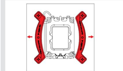
Fixieren Sie die Montagebrücken mit den 4 NM-ITS1 Rändelschrauben.
