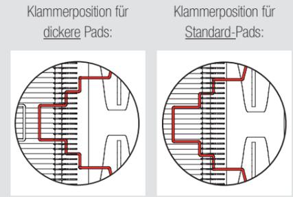
Noctua empfiehlt für beste Resultate im Doppellüfter-Betrieb die Verwendung eines original NF-F12 Lüfters. Die zusätzlichen Lüfterklammern können jedoch auch zur Befestigung vieler anderer handelsüblicher 120mm Lüfter verwendet werden. Nutzen Sie in diesem Fall bitte die mitgelieferten selbstklebenden Anti-Vibrations-Streifen, um die Übertragung von Vibrationen auf den Kühlkörper zu minimieren.
