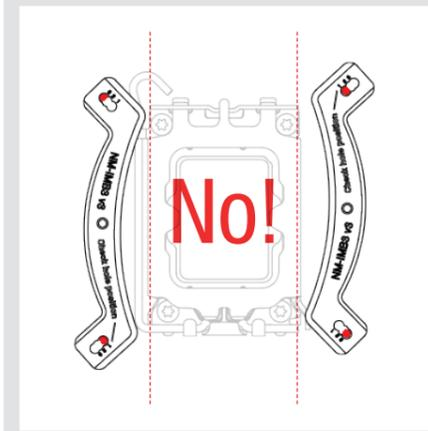
Stecken Sie zunächst die Kunststoffhülsen und anschließend die Montagebrücken auf die Stützen.
