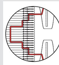
Noctua empfiehlt für beste Resultate im Doppellüfter-Betrieb die Verwendung eines original NF-F12 Lüfters. Die zusätzlichen Lüfterklammern können jedoch auch zur Befestigung vieler anderer handelsüblicher 120mm Lüfter verwendet werden. Nutzen Sie in diesem Fall bitte die mitgelieferten selbstklebenden Anti-Vibrations Streifen, um die Übertragung von Vibrationen auf den Kühlkörper zu minimieren.
