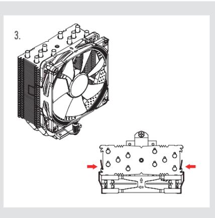
Schließen Sie den Lüfter am CPU-Lüfteranschluss Ihres Motherboards an. Je nach CPU- und Gehäusetemperatur können Sie die mitgelieferten NA-RC6 Low-Noise Adapter (L.N.A.) zwischenschalten, um das Betriebsgeräusch des Lüfters weiter zu reduzieren.
