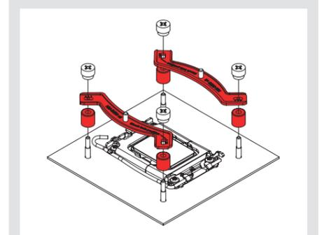
**Achtung:** Wählen Sie die Ausrichtung der Montagebrücken gemäß der gewünschten Orientierung des Kühlers.
