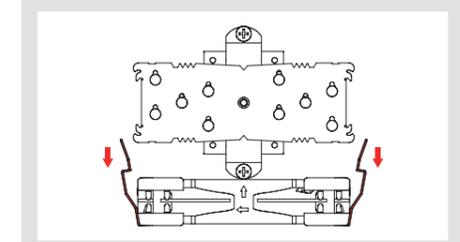
Setzen Sie anschließend den Kühler auf die CPU und schrauben Sie ihn an die Schraubenstützen der Montagebrücken. Führen Sie jeweils 2-3 Umdrehungen pro Schraube aus und wechseln Sie zwischen den Schrauben hin und her, bis beide vollständig angezogen sind.
