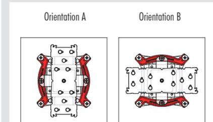
**Achtung:** Stellen Sie sicher, dass die Biegungen der Montagebrücken nach außen zeigen.
