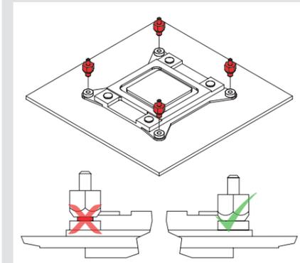
Setzen Sie nun die NM-IMB3 Montagebrücken auf die Bolzen.
