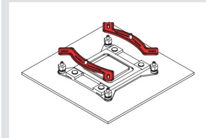
**Achtung:** Wählen Sie die Ausrichtung der Montagebrücken gemäß der gewünschten Orientierung des Kühlers.
