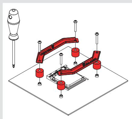
**Achtung:** Stellen Sie sicher, dass die Biegungen der Montagebrücken nach außen zeigen.
