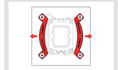
Fixieren Sie die Montagebrücken mit den 4 NM-ITS1 Rändelschrauben.
