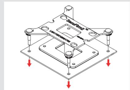
**Precaución:** La placa de soporte que se incluye se instalará sobre el soporte de la placa base, por lo que este último soporte no deberá retirarse.
