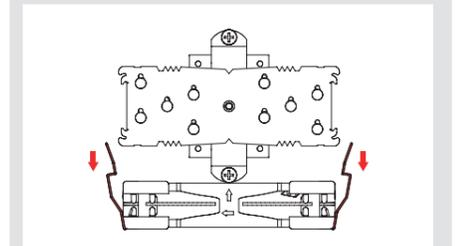
Coloque a continuación el disipador sobre la CPU y atorníllelo a los orificios de las barras de montaje. Dé 2-3 vueltas en cada tornillo, después repita la operación hasta que ambos estén completamente apretados.
