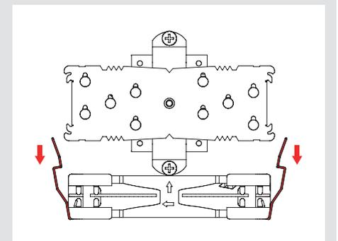
Coloque a continuación el disipador sobre la CPU y atornillelo a los orificios de las barras de montaje.
