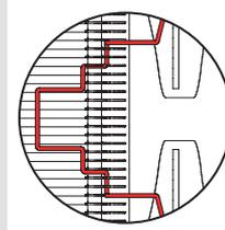
Aunque Noctua recomienda utilizar un ventilador NF-F12 para conseguir los mejores resultados cuando se opta por el modo de ventilador doble, el juego extra de clips puede utilizarse también para instalar la mayoría de ventiladores. En este caso, pegue las tiras adhesivas anti vibración en el disipador para evitar que las vibraciones se transmitan al disipador.
