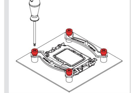
**Precaución:** Apriete los tornillos con cuidado hasta que se detengan, sin aplicar demasiada fuerza (max. par de fuerza 0,6 Nm).
