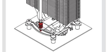
**Precaución:** Apriete los tornillos con cuidado hasta que se detengan, sin aplicar demasiada fuerza (max. par de fuerza 0,6 Nm).
