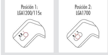
**Precaución:** Compruebe que utiliza la posición correcta del orificio en ambos extremos de las barras de montaje para que estén bien alineadas.
