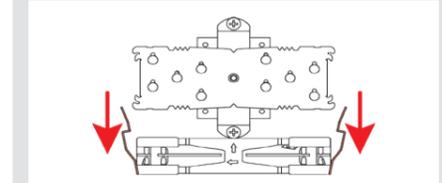
Setzen Sie anschließend den Kühler auf die CPU und schrauben Sie ihn an die Schraubenstützen der Montagebrücken. Führen Sie jeweils 2-3 Umdrehungen pro Schraube aus und wechseln Sie zwischen den Schrauben hin und her, bis beide vollständig angezogen sind.
