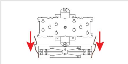
Setzen Sie anschließend den Kühler auf die CPU und schrauben Sie ihn an die Schraubenstützen der Montagebrücken. Führen Sie jeweils 2-3 Umdrehungen pro Schraube aus und wechseln Sie zwischen den Schrauben hin und her, bis beide vollständig angezogen sind.
