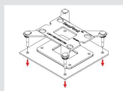
**Achtung:** Die ab Werk am Mainboard verbaute Backplate darf nicht abgenommen werden. Die Backplate des Kühlers wird über der Backplate des Mainboards installiert.
