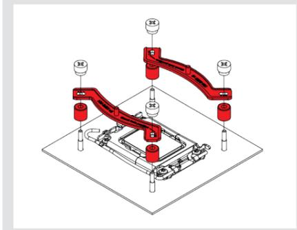
**Achtung:** Wählen Sie die Ausrichtung der Montagebrücken gemäß der gewünschten Orientierung des Kühlers.
