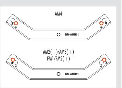
Setzen Sie zunächst die Kunststoffhülsen auf die Gewindestutzen und befestigen Sie anschließend die Montagebrücken mit den vier langen NM-ALS1 Schrauben.
