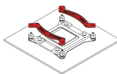
**Precaución:** Escoja la alineación de las barras de montaje de acuerdo con la orientación final que desee para el disipador.
