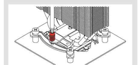
**Precaución:** Apriete los tornillos con cuidado hasta que se detengan, sin aplicar demasiada fuerza (max. par de fuerza 0,6 Nm).
