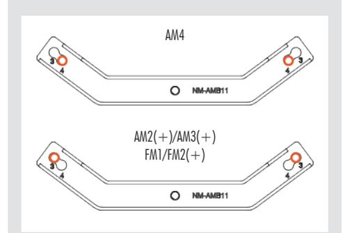
En primer lugar, coloque los separadores de plástico en los tornillos de la placa de soporte y, después, coloque las barras de montaje, fijándolas con los cuatro tornillos largos.
