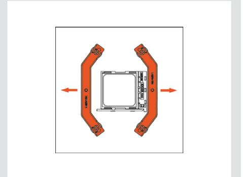
**Precaución:** Apriete los tornillos con cuidado hasta que se detengan, sin aplicar demasiada fuerza (max. par de fuerza 0,6 Nm).
