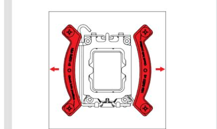
Sujete las barras de montaje con los 4 tornillos de ajuste manual.
