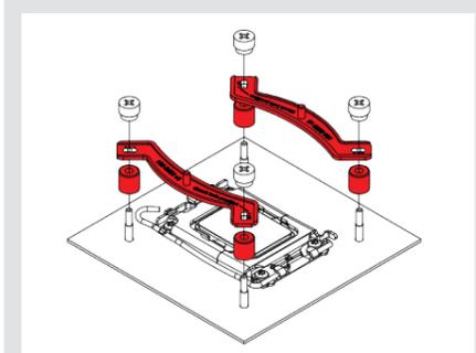
**Precaución:** Elija la alineación de las barras de montaje dependiendo de la orientación final que se desee para el disipador.
