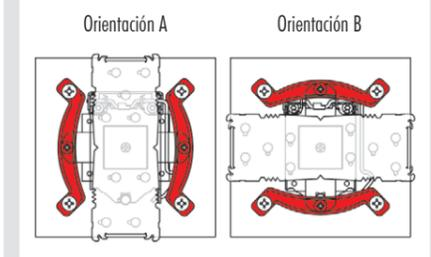
**Precaución:** Compruebe que los lados curvados de las barras de montaje estén orientados hacia afuera.
