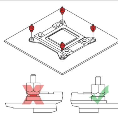
Posteriormente, coloque las barras de montaje NM-IMB3 en los tornillos.
