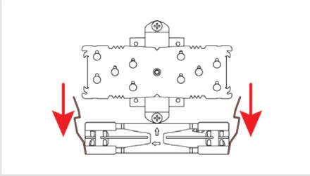
Coloque a continuación el disipador sobre la CPU y atornillelo a los orificios de las barras de montaje. Dé 2-3 vueltas en cada tornillo, después repita la operación hasta que ambos estén completamente apretados.
