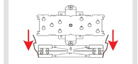
Coloque a continuación el disipador sobre la CPU y atornillelo a los orificios de las barras de montaje. Dé 2-3 vueltas en cada tornillo, después repita la operación hasta que ambos estén completamente apretados.
