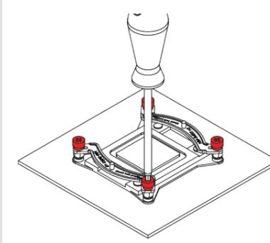
**Precaución:** Apriete los tornillos con cuidado hasta que se detengan, sin aplicar demasiada fuerza (max. par de fuerza 0,6 Nm).
