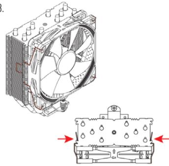
Conecte el ventilador al conector de alimentación de la CPU de la placa base. Dependiendo de su CPU y de la temperatura en el interior de la caja, puede interconectar el adaptador para la reducción de ruido (L.N.A.) NA-RC6 para reducir todavía más el ruido del ventilador en funcionamiento.
