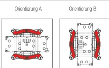
**Achtung:** Stellen Sie sicher, dass die Biegungen der Montagebrücken nach außen zeigen.
