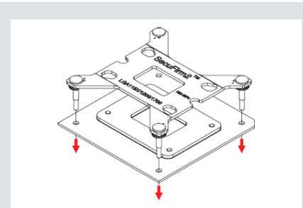
**Achtung:** Die ab Werk am Mainboard verbaute Backplate darf nicht abgenommen werden. Die Backplate des Kühlers wird über der Backplate des Mainboards installiert.
