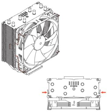
Schließen Sie den Lüfter am CPU-Lüfteranschluss Ihres Mainboards an. Wenn Sie die Kühlleistung Ihres NH-U12S redux weiter verbessern möchten, können Sie mittels des optionalen NA-FK1 Zweitlüfter-Sets einen zweiten NF-P12 redux-1700 PWM Lüfter montieren, um eine noch höhere Effizienz zu erzielen.
