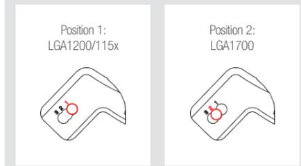
**Achtung:** Verwenden Sie unbedingt an beiden Enden der Montagebrücken die korrekte Lochposition, um eine versetzte Montage zu vermeiden.
