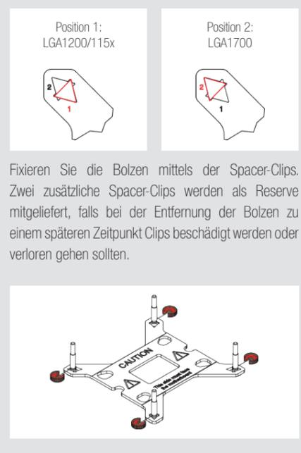
Fixieren Sie die Bolzen mittels der Spacer-Clips. Zwei zusätzliche Spacer-Clips werden als Reserve mitgeliefert, falls bei der Entfernung der Bolzen zu einem späteren Zeitpunkt Clips beschädigt werden oder verloren gehen sollten.
