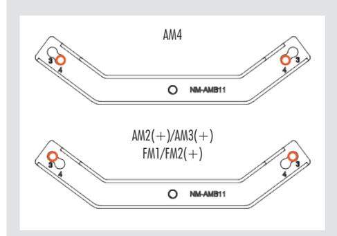
Setzen Sie zunächst die Kunststoffhülsen auf die Gewindestutzen und befestigen Sie anschließend die Montagebrücken mit den vier langen NM-ALS1 Schrauben.
