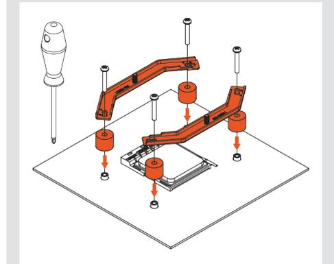
**Achtung:** Stellen Sie sicher, dass die Biegungen der Montagebrücken nach außen zeigen.
