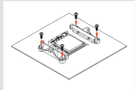
Falls auf Ihrem Mainboard kein Retention-Modul vormontiert ist, sollten Sie mit dem Mainboard-Zubehör eine originale AMD-Backplate erhalten haben. Setzen Sie die Backplate so auf die Rückseite des Mainboards, dass die Gewindestutzen der Backplate wie unten dargestellt durch die Montagelöcher des Mainboards ragen. Falls bei Ihrem Mainboard keine Backplate vormontiert oder mitgeliefert sein sollte, kontaktieren Sie bitte unser Support-Team [support@noctua.at](mailto:support@noctua.at).
