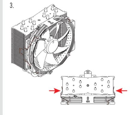
Schließen Sie den Lüfter am CPU-Lüfteranschluss Ihres Motherboards an. Je nach CPU- und Gehäusetemperatur können Sie die mitgelieferten NA-RC6 Low-Noise Adapter (L.N.A.) zwischenschalten, um das Betriebsgeräusch des Lüfters weiter zu reduzieren.
