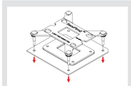
**Achtung:** Die ab Werk am Mainboard verbaute Backplate darf nicht abgenommen werden. Die Backplate des Kühlers wird über der Backplate des Mainboards installiert.
