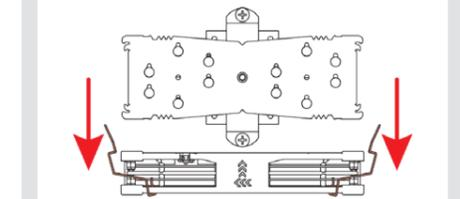
Setzen Sie anschließend den Kühler auf die CPU und schrauben Sie ihn an die Schraubenstützen der Montagebrücken. Führen Sie jeweils 2-3 Umdrehungen pro Schraube aus und wechseln Sie zwischen den Schrauben hin und her, bis beide vollständig angezogen sind.
