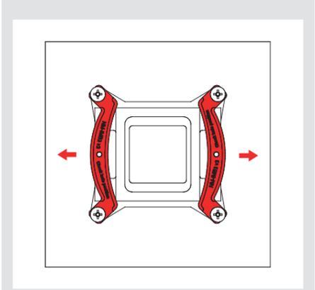
Fixieren Sie die Montagebrücken mit den 4 NM-ITS1s Rändelschrauben.
