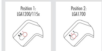
**Achtung:** Verwenden Sie unbedingt an beiden Enden der Montagebrücken die korrekte Lochposition, um eine versetzte Montage zu vermeiden.
