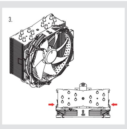
Schließen Sie den Lüfter am CPU-Lüfteranschluss Ihres Mainboards an.
