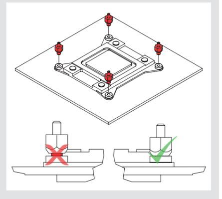
Setzen Sie nun die NM-IMB2 Montagebrücken auf die Bolzen.
