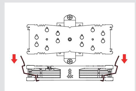
Setzen Sie anschließend den Kühler auf die CPU und schrauben Sie ihn an die Schraubstützen der Montagebrücken. Führen Sie jeweils 2-3 Umdrehungen pro Schraube aus und wechseln Sie zwischen den Schrauben hin und her, bis beide vollständig angezogen sind.
