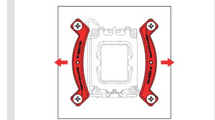
Fixieren Sie die Montagebrücken mit den 4 Rändelschrauben.
