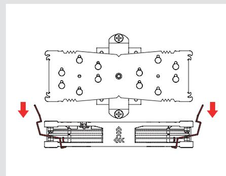
Coloque a continuación el disipador sobre la CPU y atornille a los orificios de las barras de montaje.
