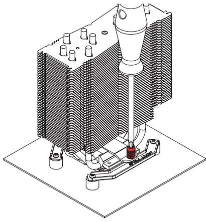
**Precaución:** Apriete los tornillos hasta que se detengan.
