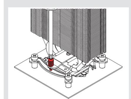
**Precaución:** Apriete los tornillos hasta que se detengan.
