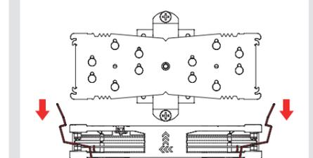
Coloque a continuación el disipador sobre la CPU y atornillelo a los orificios de las barras de montaje.
