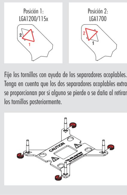
Fije los tornillos con ayuda de los separadores acoplables. Tenga en cuenta que los dos separadores acoplables extra se proporcionan por si alguno se pierde o se daña al retirar los tornillos posteriormente.
