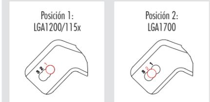
**Precaución:** Compruebe que utiliza la posición correcta del orificio en ambos extremos de las barras de montaje para que estén bien alineadas.
