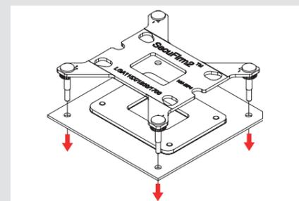
**Precaución:** La placa de soporte que se incluye se instalará sobre el soporte de la placa base, por lo que este último soporte no deberá retirarse.
