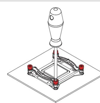
**Precaución:** Apriete los tornillos con cuidado hasta que se detengan, sin aplicar demasiada fuerza (max. par de fuerza 0,6 Nm).
