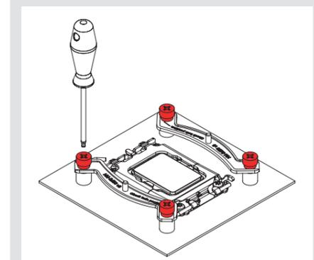
**Precaución:** Apriete los tornillos con cuidado hasta que se detengan, sin aplicar demasiada fuerza (max. par de fuerza 0.6 Nm).
