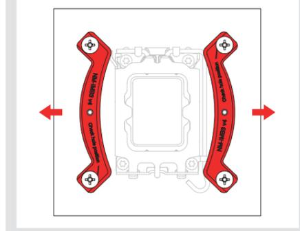
Sujete las barras de montaje con los cuatro tornillos de ajuste manual NM-ITS1.
