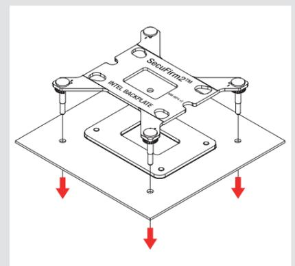
**Precaución:** La placa de soporte que se incluye se instalará sobre el soporte de la placa base, por lo que este último soporte no deberá retirarse.
