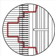
Aunque Noctua recomienda utilizar un ventilador NF-A15 para conseguir los mejores resultados cuando se opta por el modo de ventilador doble, el juego extra de clips puede utilizarse también para instalar la mayoría de ventiladores. En este caso, pegue las tiras adhesivas antivibración en el disipador para evitar que las vibraciones se transmitan al disipador.
