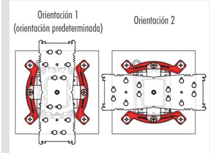
**Precaución:** Compruebe que los lados curvados de las barras de montaje estén orientados hacia afuera.
