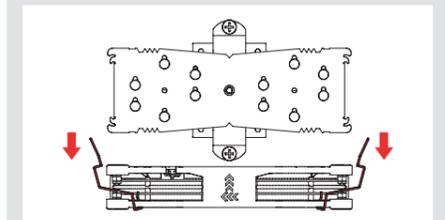
Coloque a continuación el disipador sobre la CPU y atorníllelo a los orificios de las barras de montaje.
