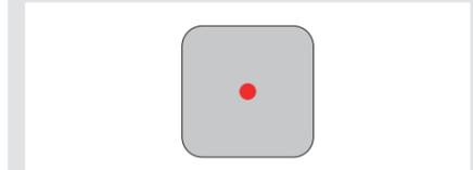
**Precaución:** Aplicar demasiada pasta térmica reducirá la conductividad del calor y el rendimiento de refrigeración.
