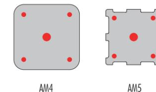
**Precaución:** Aplicar demasiada pasta térmica reducirá la conductividad del calor y el rendimiento de refrigeración.
