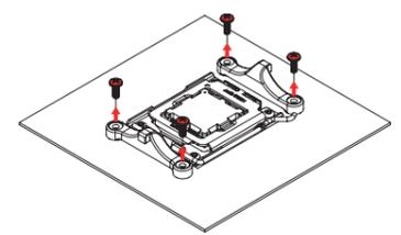
En el caso de AM4, la placa de soporte se afloja al desatornillar el módulo de retención, por lo que tendrá que sujetarla para el siguiente paso. Si ha perdido la placa de soporte AM4, póngase en contacto con nosotros en la siguiente dirección: [support@noctua.at](mailto:support@noctua.at). En el caso de AM5, la placa de soporte se sujeta con tornillos al socket, por lo que, simplemente, permanecerá en su lugar.
