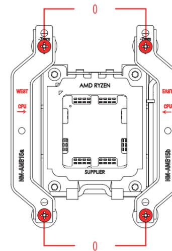
**Precaución:** Compruebe que las marcas "CPU →" apuntan hacia la CPU y que la barra NM-AMB15a con la indicación "WEST" se instala en el lado oeste (izquierdo) del socket; y que la barra NM-AMB15b con la indicación "EAST" se instala en el lado este (derecho) del socket, como se muestra anteriormente.
