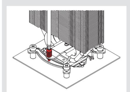
**Precaución:** Apriete los tornillos hasta que se detengan.
