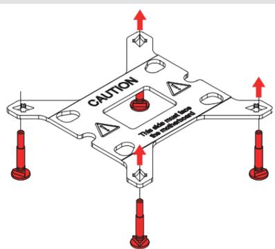
Utilice la posición 1 del orificio para LGA1200/LGA115x (LGA1150, LGA1151, LGA1155, LGA1156) y la posición 2 para LGA1851/LGA1700:
