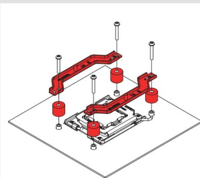
Para los procesadores AM5 y AM4 Ryzen de las series 5000/3000, elija la posición del orificio desplazado -7mm para garantizar un rendimiento y calidad de contacto óptimos.
