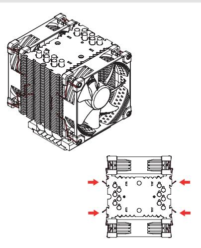
将风扇连接到主板的CPU风扇端口。如有必要，使用随带的 NA-YCL Y型线材将两个风扇连接到一个风扇接头上。
