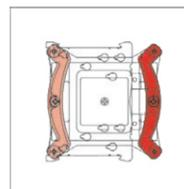
**Achtung:** Stellen Sie sicher, dass die Biegungen der Montagebrücken nach außen zeigen.
