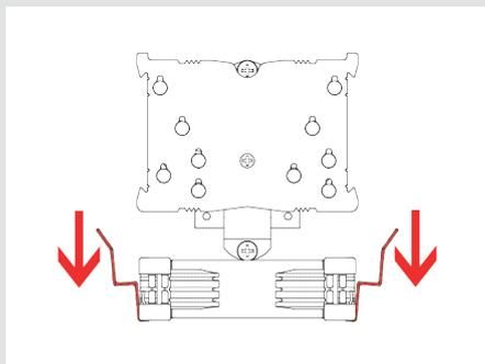
Setzen Sie anschließend den Kühler auf die CPU und schrauben Sie ihn an die Schraubenstützen der Montagebrücken. Führen Sie jeweils 2-3 Umdrehungen pro Schraube aus und wechseln Sie zwischen den Schrauben hin und her, bis beide vollständig angezogen sind.
