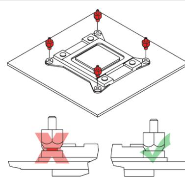
Setzen Sie nun die NM-IMB3 Montagebrücken auf die Bolzen.
