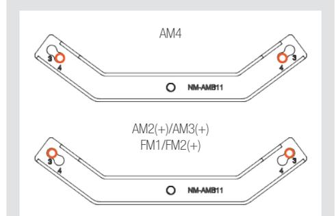
Setzen Sie zunächst die Kunststoffhülsen auf die Gewindestutzen und befestigen Sie anschließend die Montagebrücken mit den vier langen NM-ALS1 Schrauben.
