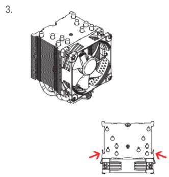
Schließen Sie den Lüfter am CPU-Lüfteranschluss Ihres Motherboards an. Je nach CPU- und Gehäuse-temperatur können Sie die mitgelieferten NA-RC7 Low-Noise Adapter (L.N.A.) zwischenschalten, um das Betriebsgeräusch des Lüfters weiter zu reduzieren.
