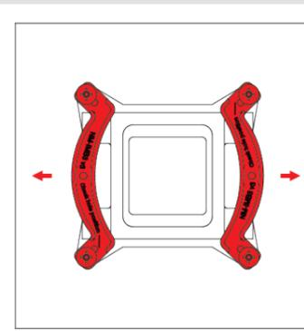
Fixieren Sie die Montagebrücken mit den 4 NM-ITS1 Rändelschrauben.
