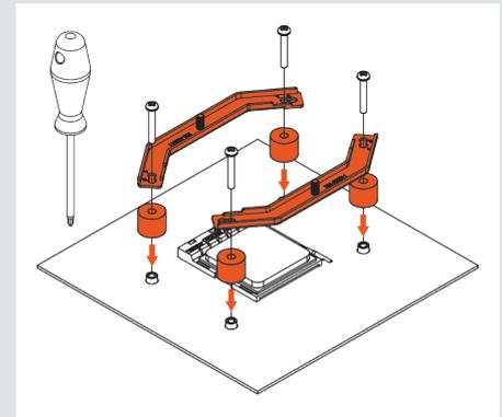
**Achtung:** Stellen Sie sicher, dass die Biegungen der Montagebrücken nach außen zeigen.
