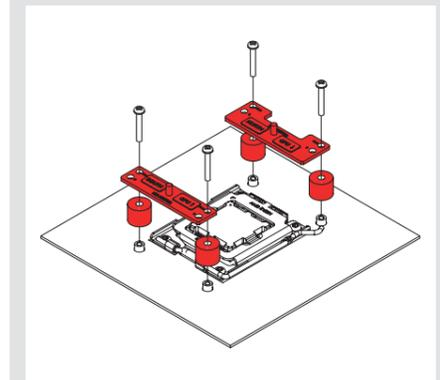
Para los procesadores AM5 y AM4 Ryzen de las series 5000/3000, elija la posición del orificio desplazado -7mm para garantizar un rendimiento y calidad de contacto óptimos.
