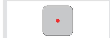
**Precaución:** Aplicar demasiada pasta térmica reducirá la conductividad del calor y el rendimiento de refrigeración.
