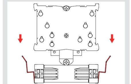
Coloque a continuación el disipador sobre la CPU y atornille a los orificios de las barras de montaje. Dé 2-3 vueltas en cada tornillo, después repita la operación hasta que ambos estén completamente apretados.
