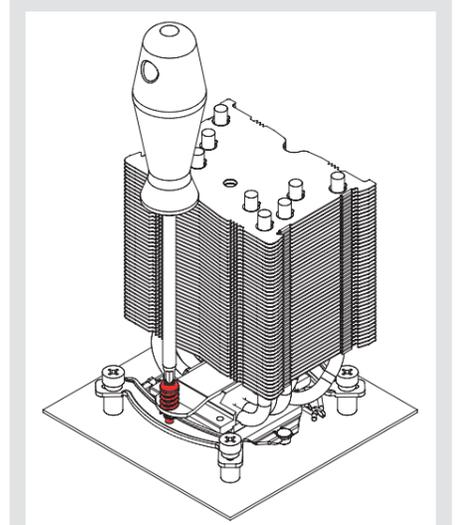
**Precaución:** Apriete los tornillos con cuidado hasta que se detengan, sin aplicar demasiada fuerza (max. par de fuerza 0,6 Nm).
