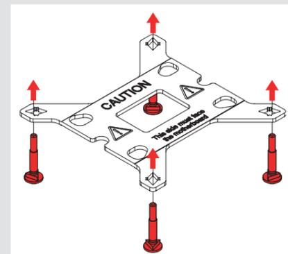
Utilice la posición 1 del orificio para LGA1200/LGA115x (LGA1150, LGA1151, LGA1155, LGA1156) y la posición 2 para LGA1851/LGA1700:
