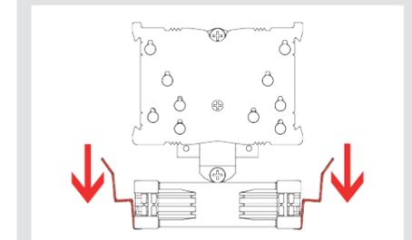
Positionnez à présent le ventirad sur le CPU et fixez celui-ci sur les filetages présents sur les étriers de montage. Commencez le serrage des vis en effectuant 2-3 tours de tournevis pour chacune d'elles puis répétez l'opération jusqu'à ce que les deux vis soient totalement serrées.
