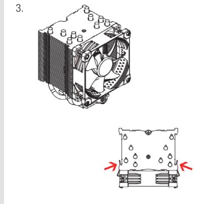
Brancher le ventilateur au connecteur de ventilation CPU situé sur la carte mère. En fonction de votre CPU et de la température au sein de votre boîtier, vous souhaitez peut-être brancher le connecteur L.N.A. (Adaptateur Faible Bruit) NA-RC7 afin de réduire encore les émissions sonores du ventilateur.
