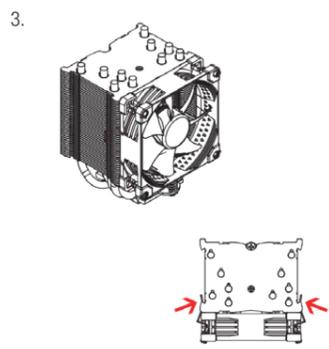
Brancher le ventilateur au connecteur de ventilation CPU situé sur la carte mère. En fonction de votre CPU et de la température au sein de votre boîtier, vous souhaitez peut-être brancher le connecteur L.N.A. (Adaptateur Faible Bruit) NA-RC7 afin de réduire encore les émissions sonores du ventilateur.
