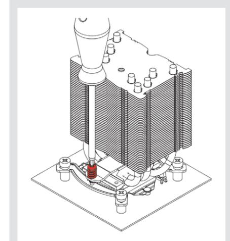
**Attention :** il est important de serrer normalement, et sans excès, les vis jusqu'à leur arrêt (max. torque 0.6 Nm).
