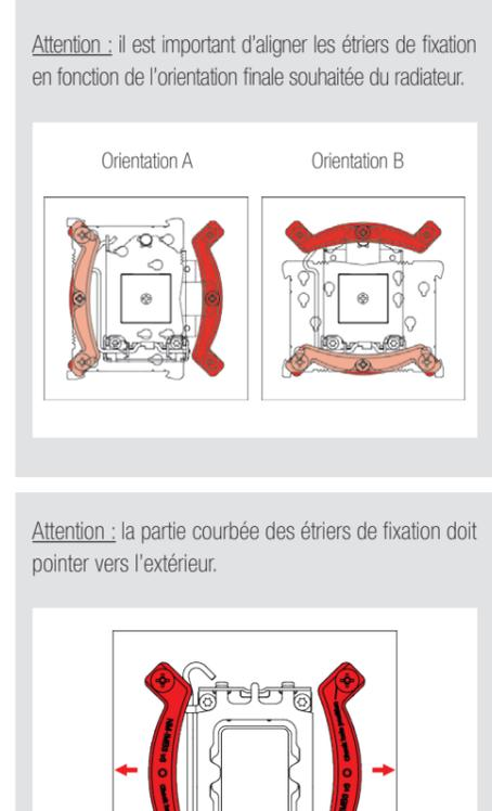
**Attention :** il est important d'aligner les étriers de fixation en fonction de l'orientation finale souhaitée du radiateur.
