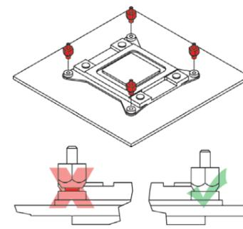
Positionnez à présent les étriers de fixation NM-IMB3 au dessus des boulons.
