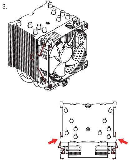
Brancher le ventilateur au connecteur de ventilation CPU situé sur la carte mère. En fonction de votre CPU et de la température au sein de votre boîtier, vous souhaitez peut-être brancher le connecteur L.N.A. (Low-Noise Adaptor) NA-RC7 afin de réduire encore les émissions sonores du ventilateur.
