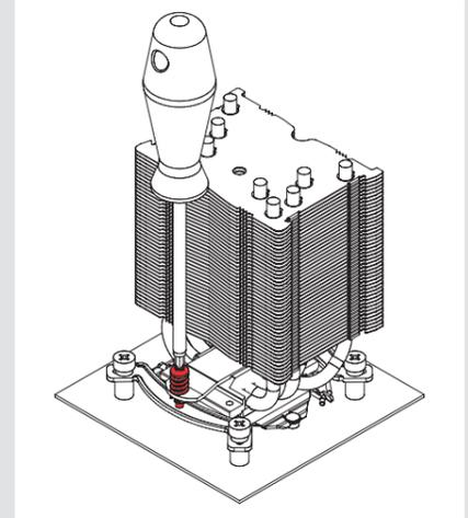
**Attention :** Il est important de serrer normalement, et sans excès, les vis jusqu'à leur arrêt (max. torque 0,6 Nm).
