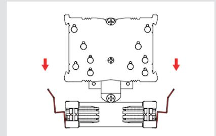
Positionnez à présent le ventilad sur le CPU et fixez celui-ci sur les filetages présents sur les étriers de montage. Commencez le serrage des vis en effectuant 2-3 tours de tournevis pour chacune d'elles puis répétez l'opération jusqu'à ce que les deux vis soient totalement serrées.
