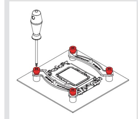
**Attention :** Il est important de serrer normalement, et sans excès, les vis jusqu'à leur arrêt (max. torqu 0,6 Nm).
