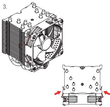
Brancher le ventilateur au connecteur de ventilation CPU situé sur la carte mère. En fonction de votre CPU et de la température au sein de votre boîtier, vous souhaitez peut-être brancher le connecteur L.N.A. (Low-Noise Adaptor) NA-RC7 afin de réduire encore les émissions sonores du ventilateur.
