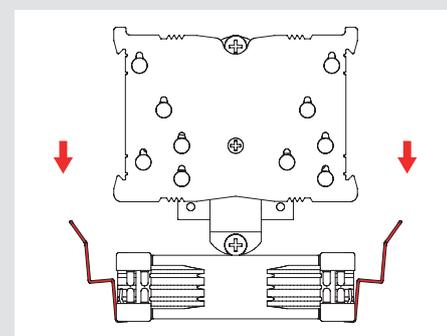
Positionnez à présent le ventirad sur le CPU et fixez celui-ci sur les filetages présents sur les étriers de montage.
