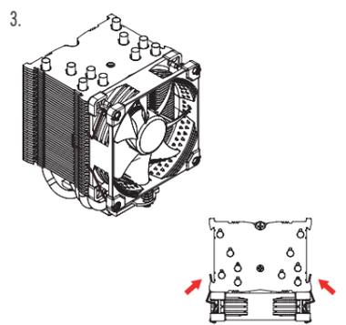
Schließen Sie den Lüfter am CPU-Lüfteranschluss Ihres Mainboards an. Je nach CPU- und Gehäusetemperatur können Sie die mitgelieferten NA-RC7 Low-Noise Adapter (L.N.A.) zwischenschalten, um das Betriebsgeräusch des Lüfters weiter zu reduzieren.
