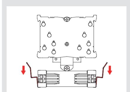
Setzen Sie anschließend den Kühler auf die CPU und schrauben Sie ihn an die Schraubenstützen der Montagebrücken. Führen Sie jeweils 2-3 Umdrehungen pro Schraube aus und wechseln Sie zwischen den Schrauben hin und her, bis beide vollständig angezogen sind.
