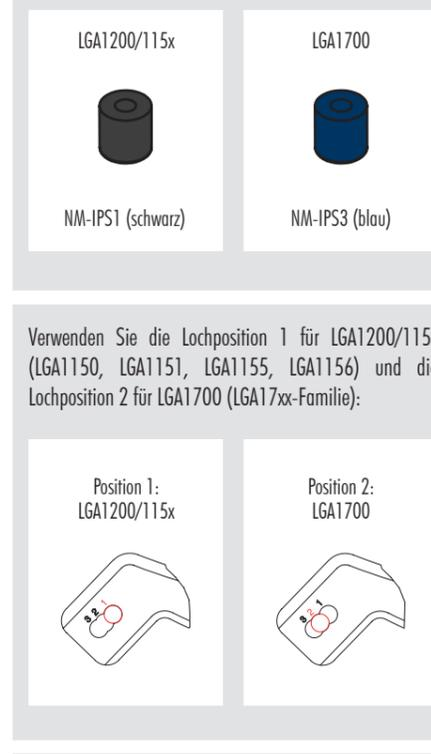
**Achtung:** Verwenden Sie unbedingt an beiden Enden der Montagebrücken die korrekte Lochposition, um eine versetzte Montage zu vermeiden.
