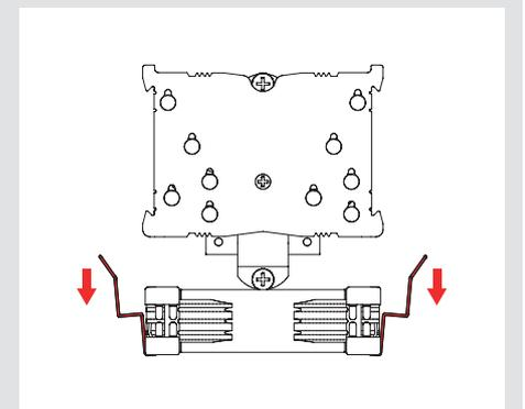
Setzen Sie anschließend den Kühler auf die CPU und schrauben Sie ihn an die Schraubenstützen der Montagebrücken.
