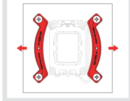
Fixieren Sie die Montagebrücken mit den 4 NM-ITS1 Rändelschrauben.
