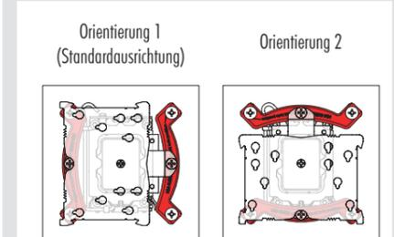
**Achtung:** Stellen Sie sicher, dass die Biegungen der Montagebrücken nach außen zeigen.
