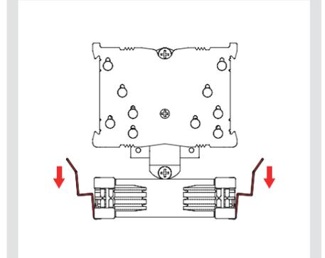
Setzen Sie anschließend den Kühler auf die CPU und schrauben Sie ihn an die Schraubenstützen der Montagebrücken. Führen Sie jeweils 2-3 Umdrehungen pro Schraube aus und wechseln Sie zwischen den Schrauben hin und her, bis beide vollständig angezogen sind.
