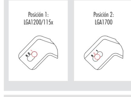
**Precaución:** Compruebe que utiliza la posición correcta del orificio en ambos extremos de las barras de montaje para que estén bien alineadas.
