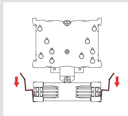
Coloque a continuación el disipador sobre la CPU y atorníllelo a los orificios de las barras de montaje.
