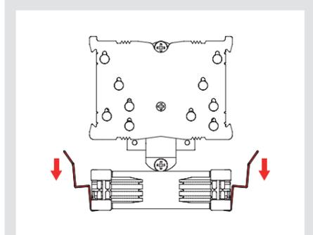
Coloque a continuación el disipador sobre la CPU y atornillelo a los orificios de las barras de montaje. Dé 2-3 vueltas en cada tornillo, después repita la operación hasta que ambos estén completamente apretados.
