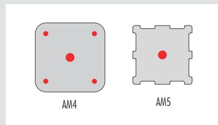
**Precaución:** Aplicar demasiada pasta térmica reducirá la conductividad del calor y el rendimiento de refrigeración.
