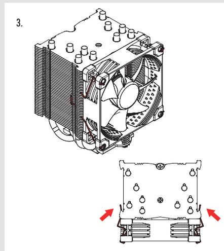
Conecte el ventilador al conector de alimentación de la CPU de la placa base.
