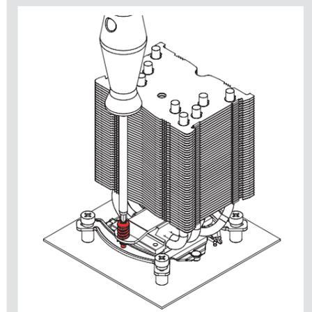
Attention : Il est important de serrer normalement, et sans excès, les vis jusqu'à leur arrêt (max. torque 0,6 Nm).
