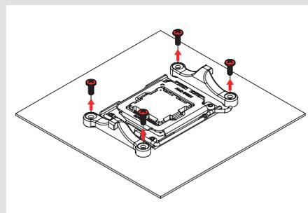
El sistema de montaje SecuFirm2™ se instalará directamente en la placa de soporte estándar, por eso, consérvela en su lugar.
