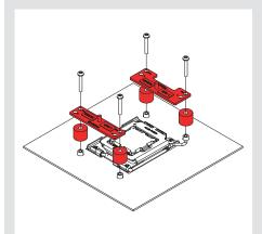
Wählen Sie für AM5 und Ryzen 5000/3000 CPUs der AM4-Serie die Offset-Position -7mm, um eine optimale Kontaktqualität und Leistung zu gewährleisten.
