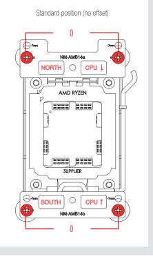
Achtung: Stellen Sie sicher, dass die Markierungen "CPU →" in Richtung der CPU zeigen und dass die NM-AMB14a Leiste Montagebrücke mit der Markierung "NORTH" auf der nördlichen (oberen) Seite des Sockels und die NM-AMB14b Montagebrücke Leiste mit der Markierung "SOUTH" auf der südlichen (unteren) Seite des Sockels.
