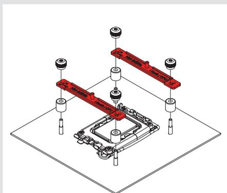
使用+3.7mm偏移位置和额外的侧向偏移（北+东偏移），可在24核或20核LGA1851 CPU上获得更好的性能。如果在兼容性限制的情况下（例如内存间隙），可以仅使用+3.7mm的位置（仅向北偏移）而不进行侧向偏移，如果这样都不行，则使用不带偏移的标准位置（0）。
