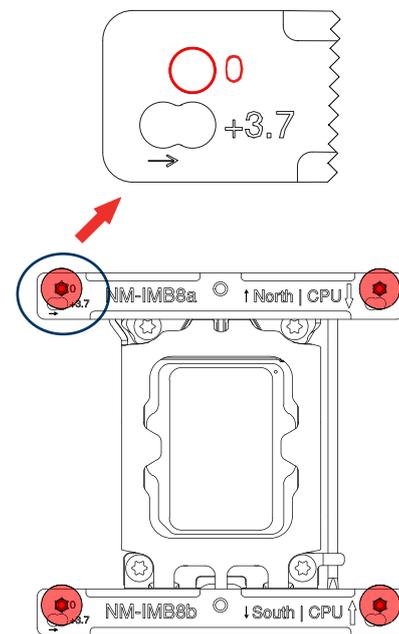
**注意：**确保“CPU ↓”以及“CPU ↑”标记指向CPU，带有“NORTH”标记的NM-IMB8a安装支架安装在插槽的北侧（顶部），带有“SOUTH”标记的NM-IMB8b安装支架安装在插槽的南侧（底部）。
