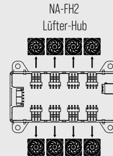
**Anwendungsbeispiel 2:** Stromversorgung und Steuerung von 12V PWM-Lüftern durch NA-FC1 (22W max.)
