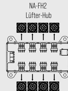
**Anwendungsbeispiel 3:** Stromversorgung über den Hohlstecker (max. 60W, 24W max. mit NV-PS1.)
