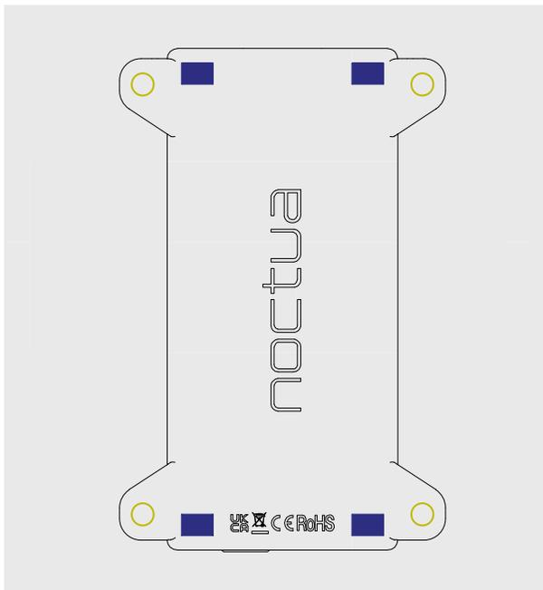
■ Schraubmontagelöcher ■ Magnete
