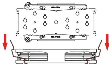
然后将散热器放在CPU上，使四个弹簧加载螺丝与CPU插槽的螺纹杆对齐。使用螺丝刀等安装工具拧紧螺钉。每次扭动3圈螺丝，然后重复，直到完全全部拧紧。
