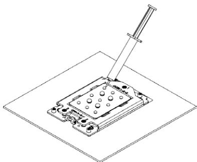
警告：添加过多的散热膏会降低其热量的导电率和散热性能。
